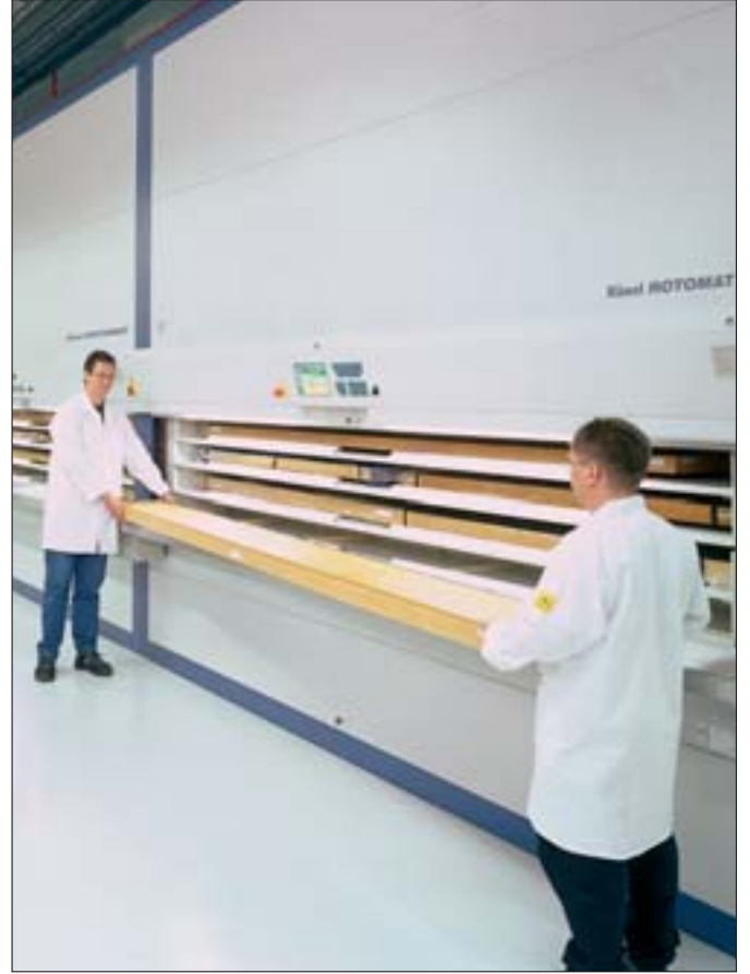
Ağır ve hacimli parçaların Rotomat® endüstriyel karusellerde güvenli depolanması
