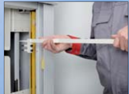
Patentli Hänel kilit cihazı ile Hänel Rotomat® endüstriyel karusel için güvenli bakım
